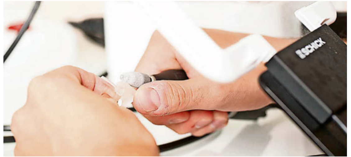
Auch handwerkliches Geschick ist im Beruf des Hörsystemakustikers gefragt. Auf dieser Abbildung sieht man den Hörsystemakustiker bei der Herstellung eines massangefertigten Ohrpaspstücks, hierbei kommt die Fräse zum Einsatz. Fotos: Akustika
