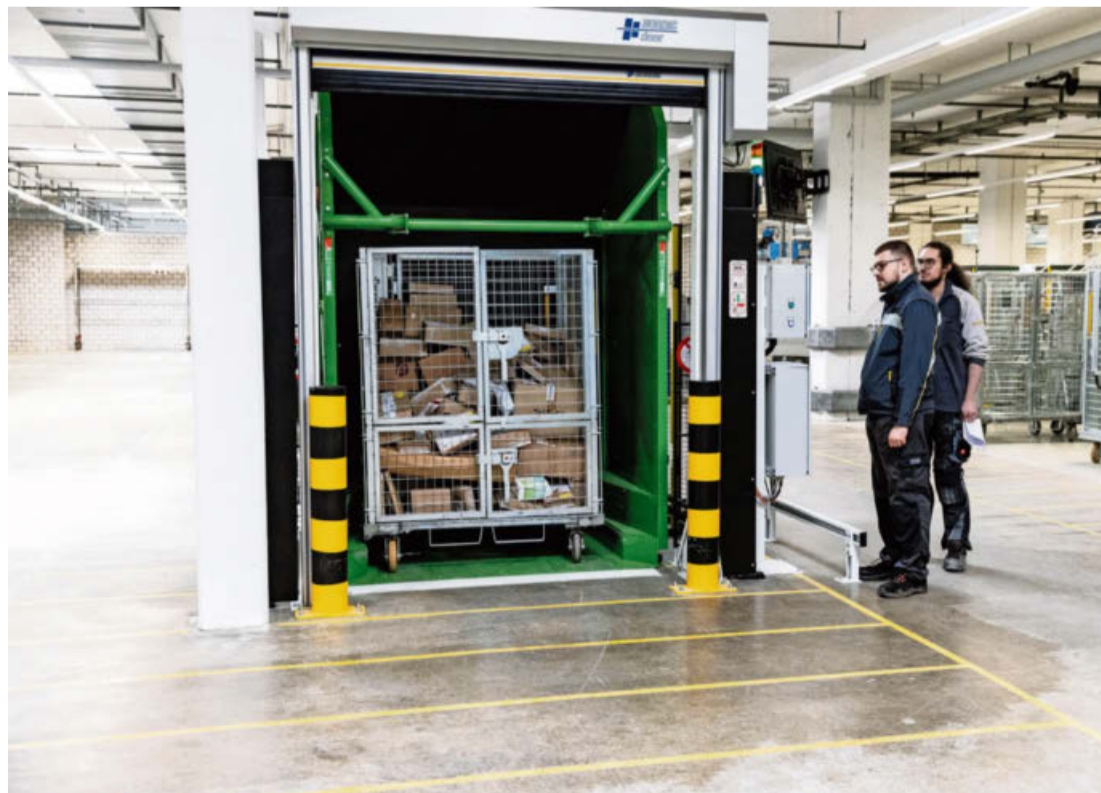
Die Gitterboxen werden mechanisch gekippt und müssen nicht mehr von Hand entladen werden. Das entlastet die Mitarbeitenden. Foto: PD
